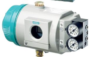
Интеллектуальный электропневматический позиционер SIPART PS2 используется для управления поворотными или линейными регулирующими клапанами. Прибор устанавливает регулирующий орган (например, МИМ) в положение, соответствующее электрическому входному управляющему сигналу. Дополнительные функциональные входы могут быть использованы для блокировки клапана или для установки в безопасное положение, они имеются в наличии в стандартной модели.
